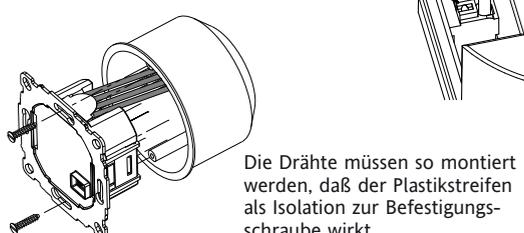
Die Drähte müssen so montiert werden, daß der Plastikstreifen als Isolation zur Befestigungsschraube wirkt.
